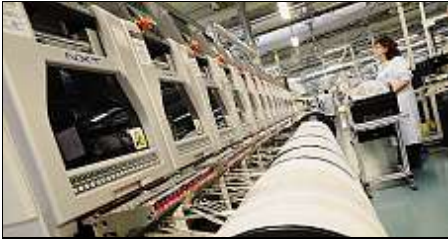
PRODUCTION. Présents sur des bobines, les composants sont ensuite insérés automatiquement sur les cartes.
