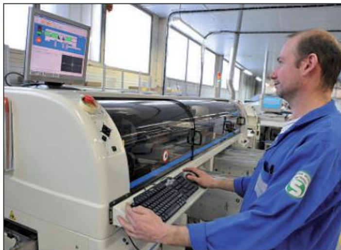
➔ Deuxième sous-traitant français, Eolane est de longue date impliqué en électronique automobile. Il compte ainsi 6 sites certifiés TS 16949. En 2012, il a installé dans son usine angevine une ligne de production dédiée aux grandes séries de cartes pour l'automobile.
